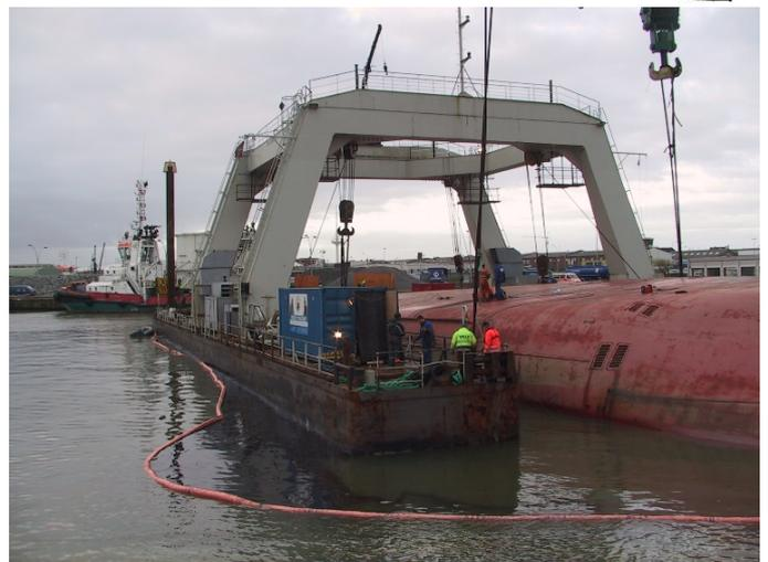
Durch das Absorbermaterial auf Polypropylen-Basis sind sie uneingeschränkt schwimmfähig, chemisch hoch beständig und verrottungsfest. Die einzelnen Sektionen werden mit Karabinerhaken und Ösen schnell zur gewünschten Einsatzlänge verbunden. Die öldichte Verbindung der Schürze erfolgt durch Klettband. Nach Gebrauch wird die Sperre in der Liefer-Verpackung zur Entsorgung, d.h. i.A. zur Verbrennung, abtransportiert.
