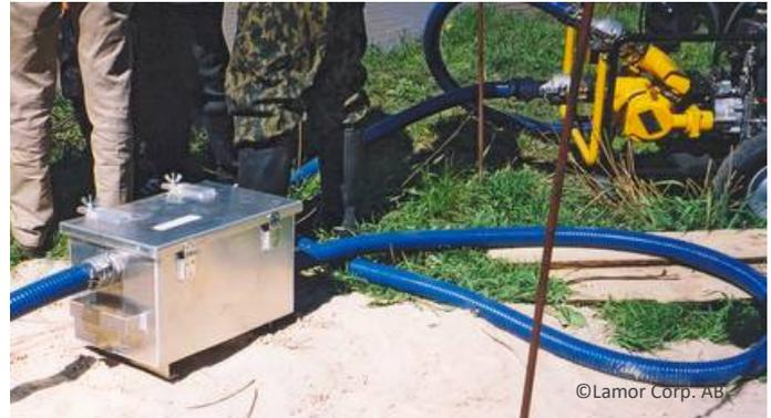
Der Steinfänger wird zwischen Rock Cleaner oder Minimax Skimmern und der Saugpumpe in die Schlauchleitung eingekuppelt.
