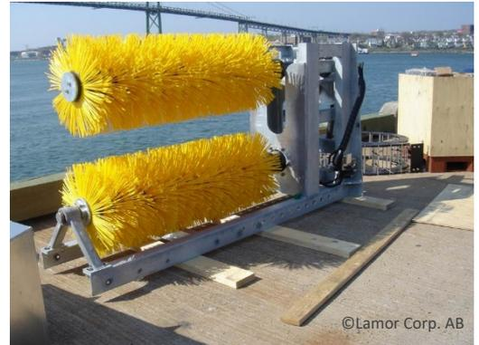
Der BWM-OTS kann zum Reinigen von Ölsperren mit einer Breite (bzw. Dicke) bis 400 mm und einer Höhe bis 2000 mm verwendet werden und enthält leicht austauschbare Bürstenringe.
