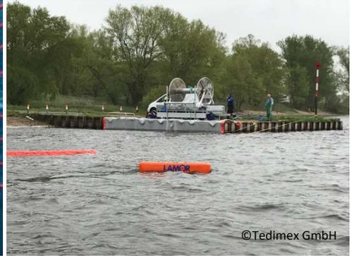
Das System kann in weniger als 30 Minuten einsatzbereit gemacht werden und gewährleistet damit die kurzfristige Reaktion auf einen Ölunfall.
